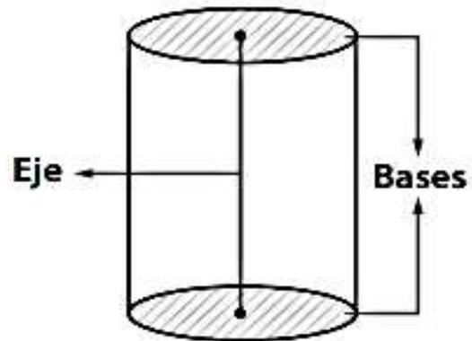
El segmento que une los centros de las bases se llama eje del **cilindro**. Si el eje es perpendicular a las bases, el cilindro es recto y la altura es la longitud de su eje.
