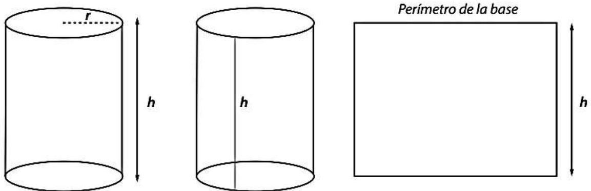
Si al cilindro se le hace un corte por la línea roja y luego se lleva la superficie del cilindro a un plano, se obtiene un rectángulo cuyas dimensiones son la altura y el perímetro de la base del cilindro.
