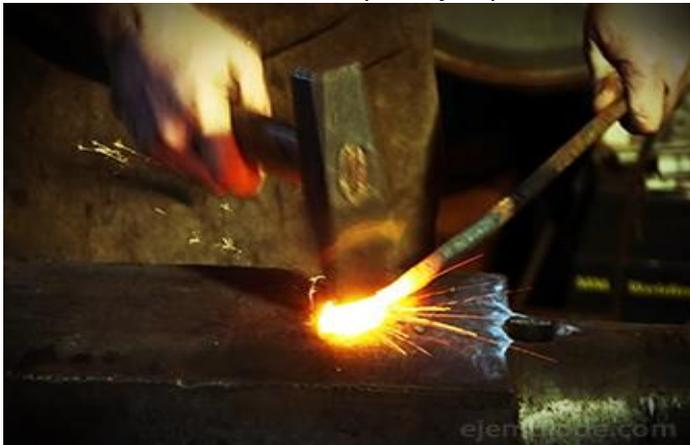
El Acero al rojo vivo puede moldearse golpeándolo constantemente, deformándolo hasta conseguir una forma deseada. En la antigüedad, así se fabricaban las espadas.
